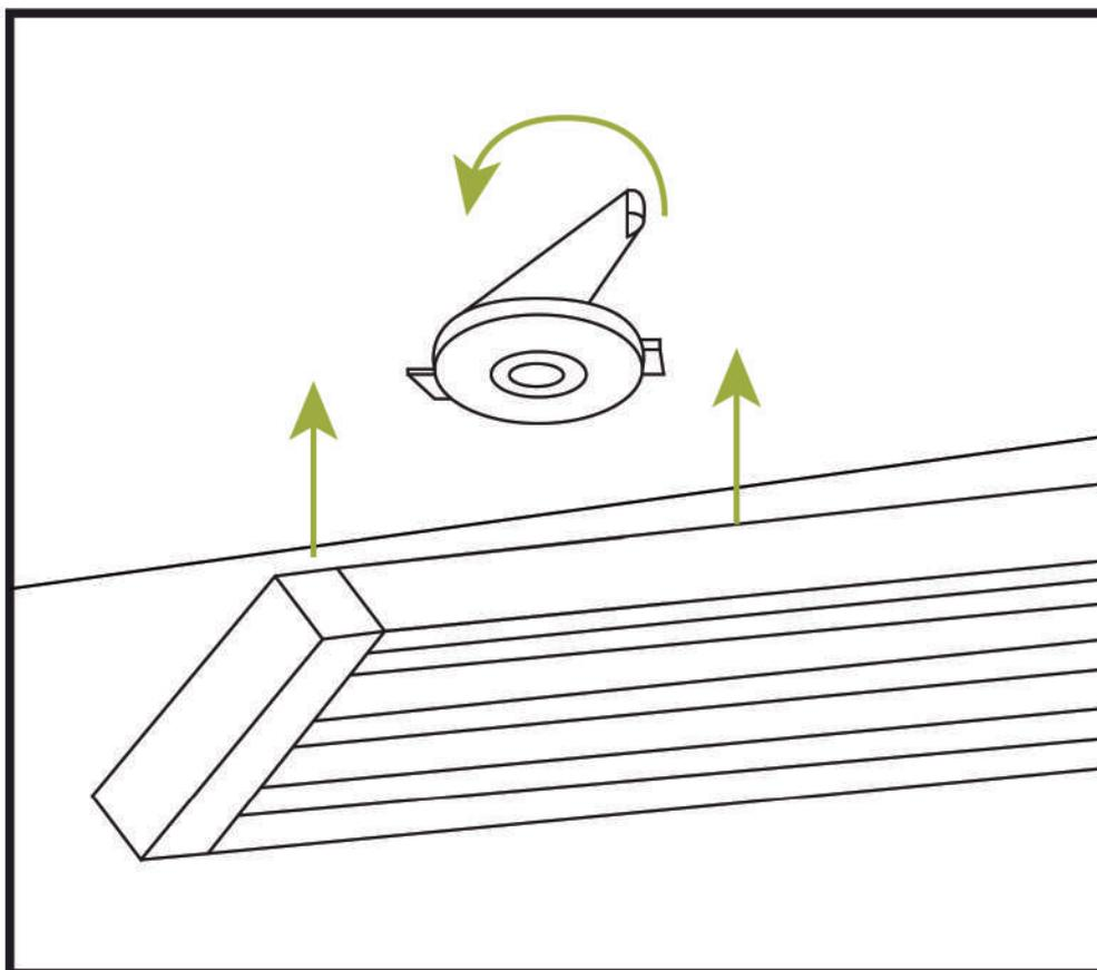
El soporte tiene una **lengüeta para ayudar a colocar y quitar el riel**, esta tiene que ir en la parte delantera. Encaja el riel y gira la lengüeta para dejar sujeto el riel.
